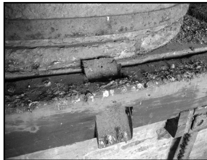
A droite, potence pour lever les meules (Photo AVH)
